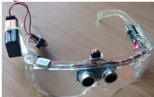
Figura 3 – Óculos com sonar funcional
