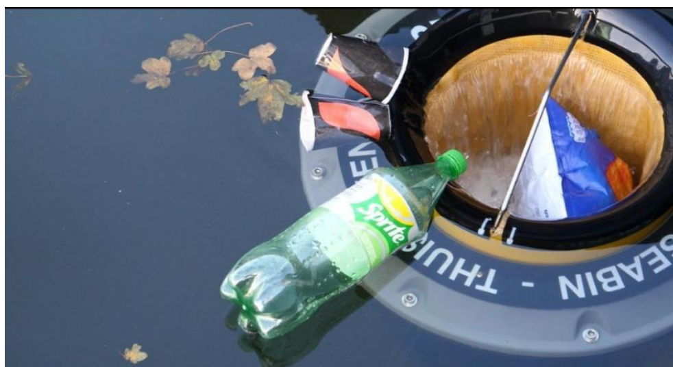
Figura 6. Sistema de coleta de detritos Seabin
