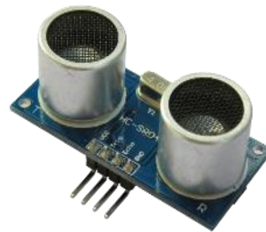
Imagem 02: HC-SR04 sensor de distancia ultrasonico con Arduino. Fonte: http://www.kurtsik.org/blog/?p=1212
