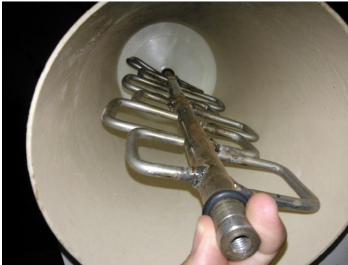
Figura 5. Agitador do tambor do biorreator de cultivo em estado sólido desenvolvido.
