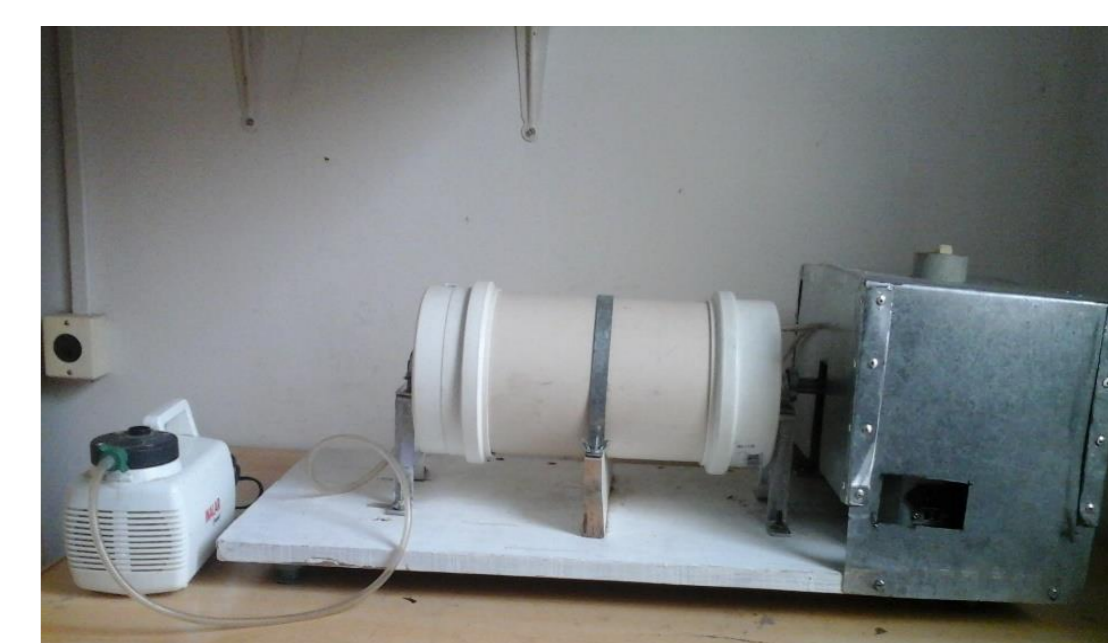
Figura 4. Biorreator de cultivo em estado sólido desenvolvido.
