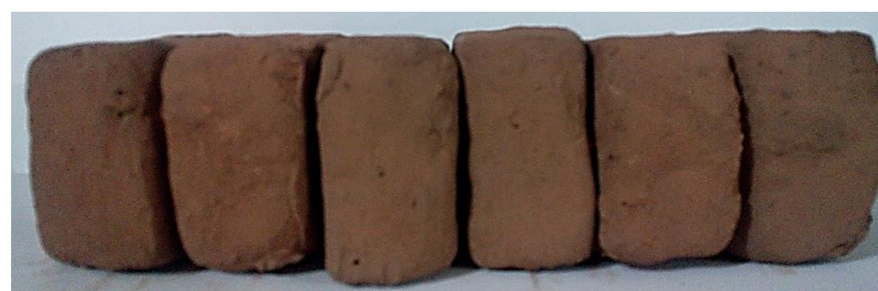
Figura 2. Protótipos de tijolos de argila e farelo de couro reconstituído.
