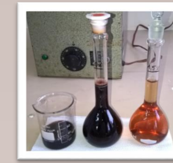
Figura 6: Diluição a 1,5% e 50% e amostra concentrada (100%) de tanino da amostra Macrospec L1.
