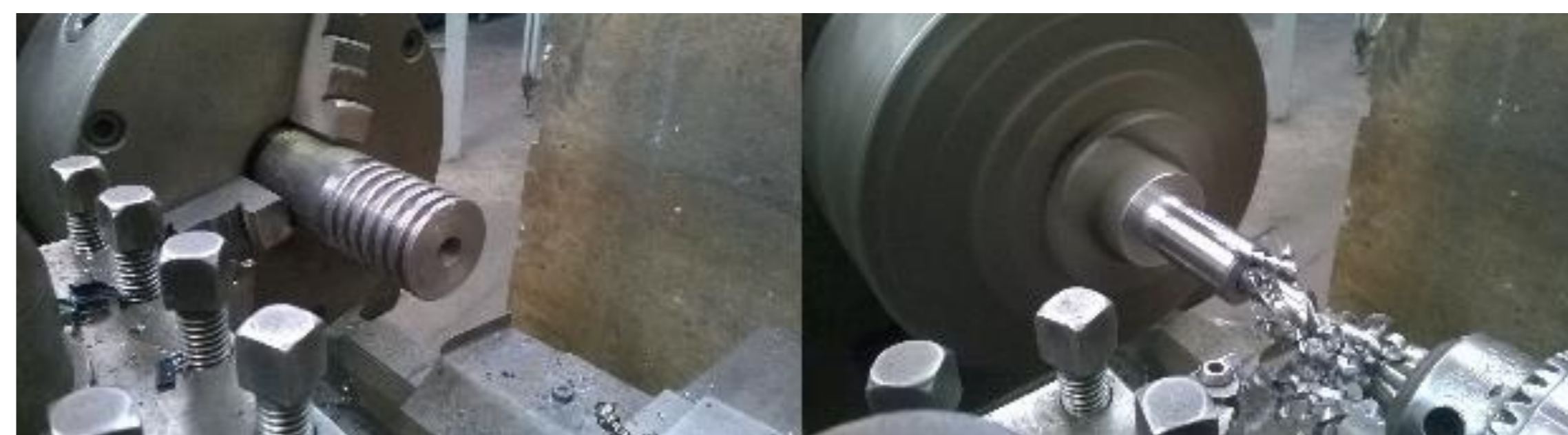
Figura 3 – Componentes do motor sendo fabricados por torneamento.
