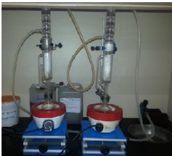
Figura 2: Extração por Soxhlet
