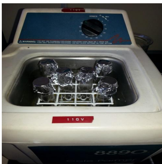
Figura 3: Tubos de ensaio imersos no aparelho de ultrassom.
