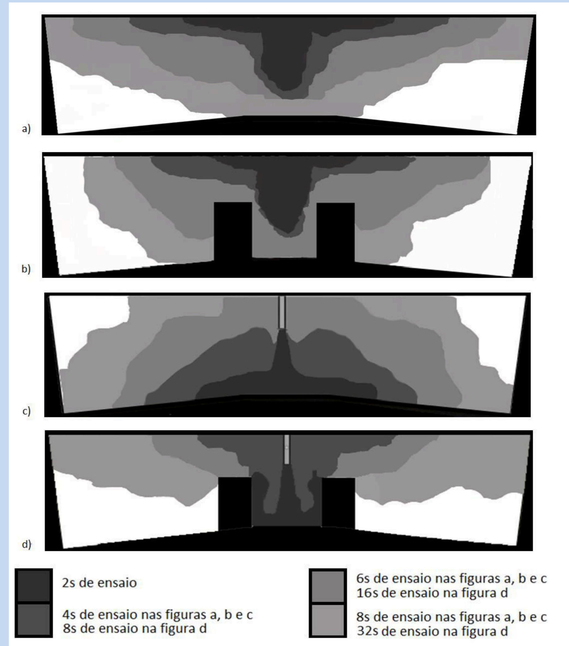
Figura 3 – Ensaios de linha de fluxo: sem tubo longo e sem barreira (a), sem tubo longo e com barreira (b), com tubo longo e com barreira (c), com tubo longo e com barreira (d).
