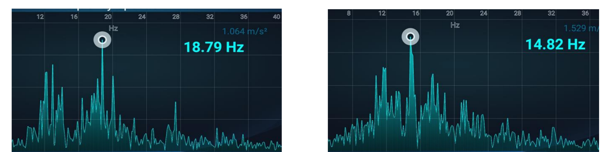
Figura 5 - Gráfico FFT Chevette Asfalto e Paralelepípedo
