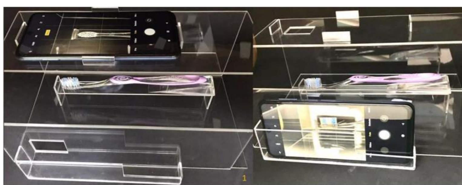
Figura 1: Protótipo de acrílico para padronização das fotografias das escovas (frontal e lateral).
