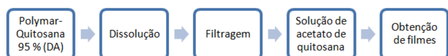
Figura 1 – Fluxograma do método de obtenção do acetato de quitosana.
