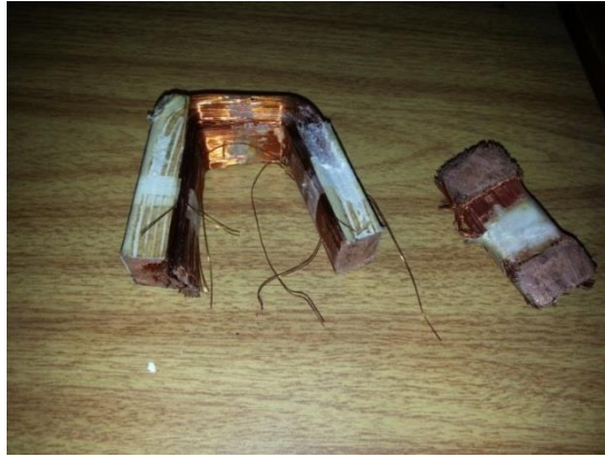
Figura 2 – Bobinado secundário retirado do transformador.
