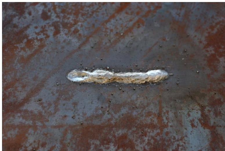
Figura 5 – Cordão de solda.
