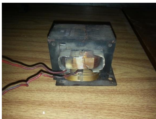
Figura 1 – Transformador de aparelho de microondas.
