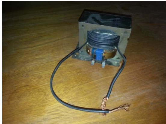
Figura 3 – Transformador com novo bobinado.
