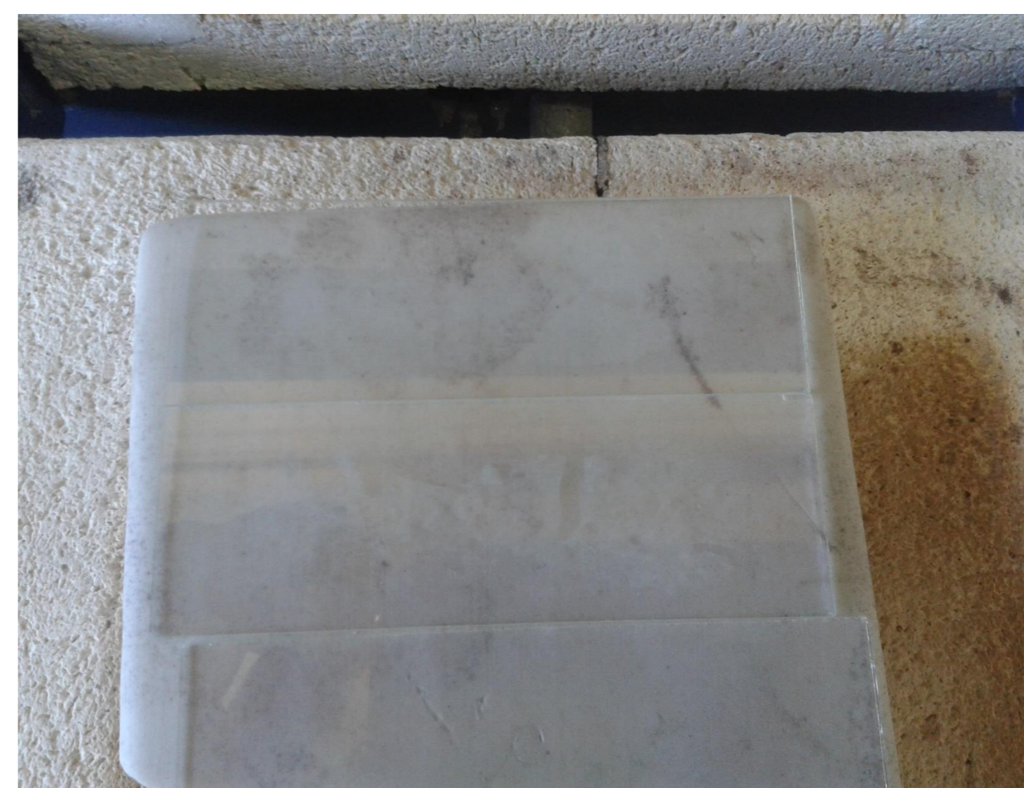
FIGURA 2 – Placas de vidro após aspersão da solução de estanho.
