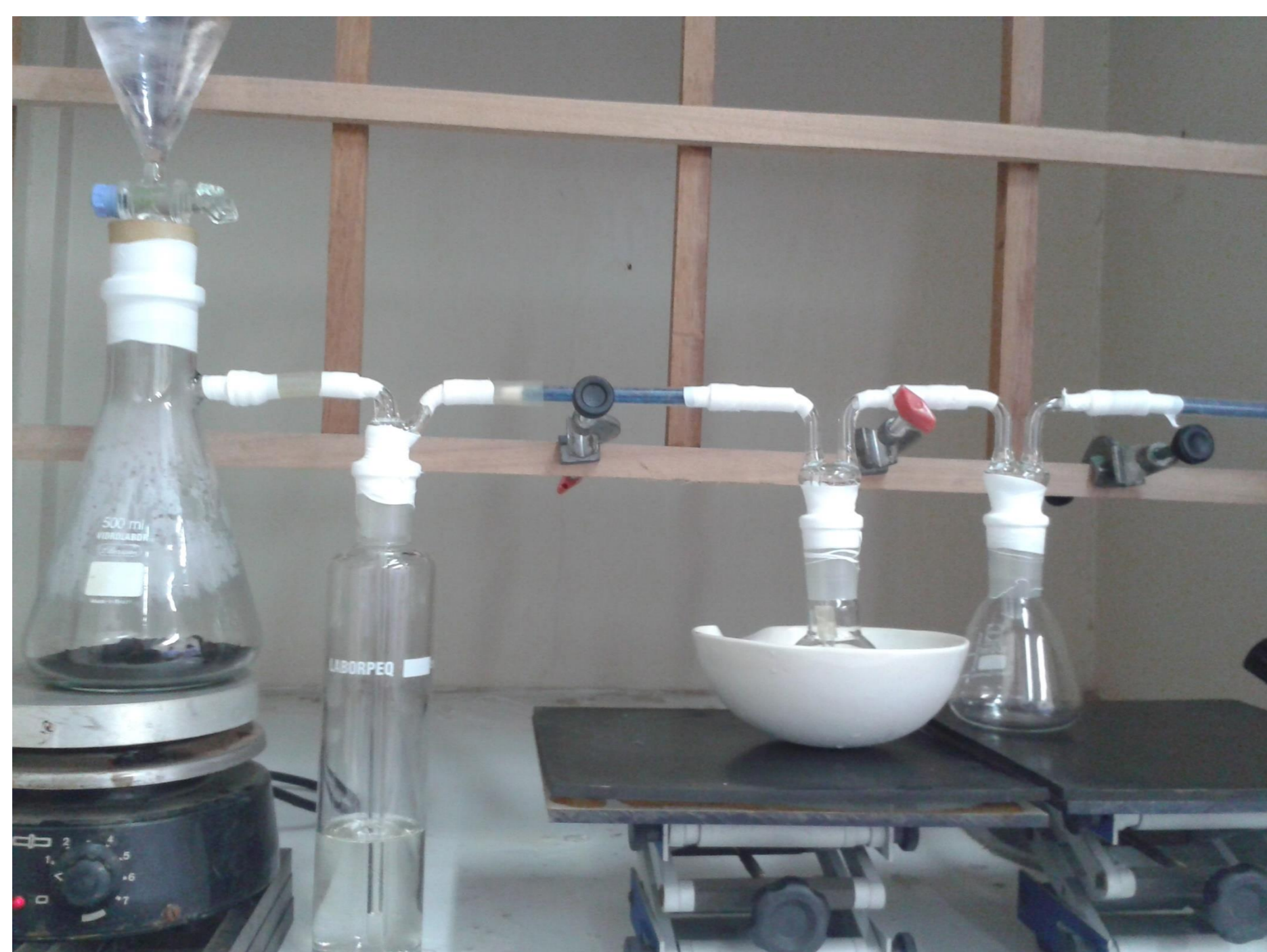
FIGURA 1 – Aparato utilizado para a síntese do cloreto estânico.
