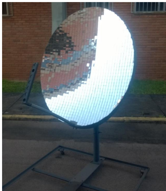
Figura 1 – Concentrador parabólico construído.
