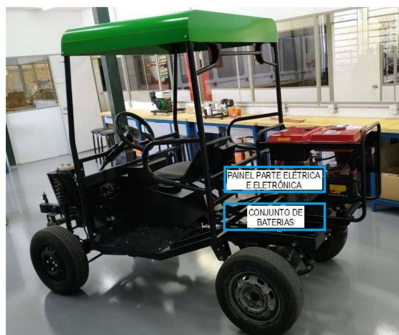
Figura 3 – Indicação da localização do Painel de Controle e Baterias no veículo
