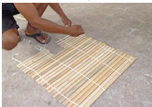
Figura 07: planificação da lateral do Matapi
