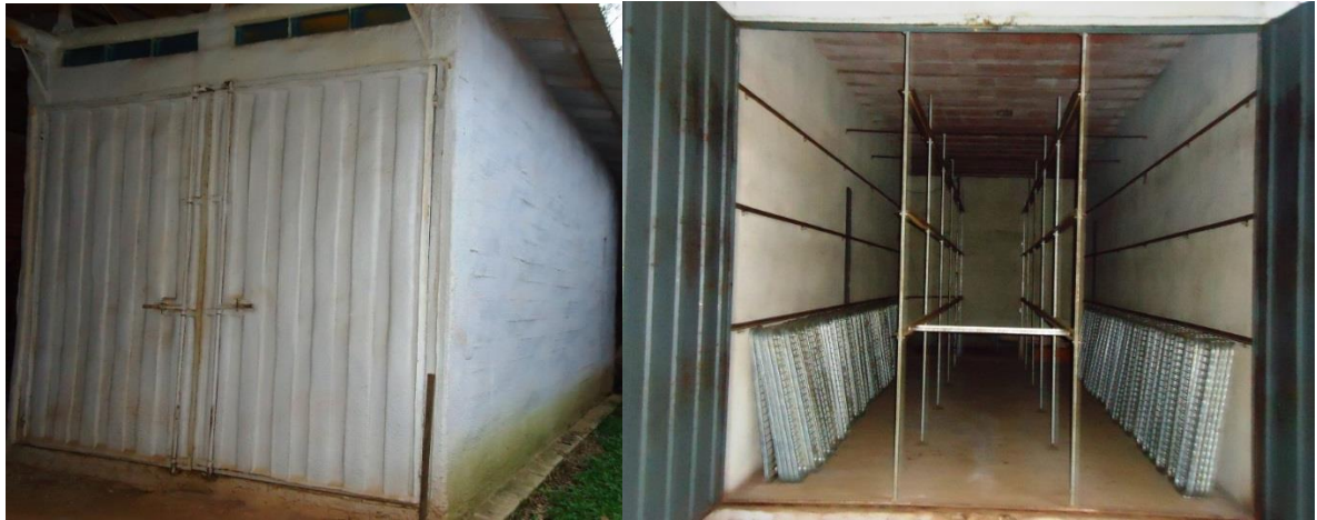
Figura 2: Estufa elétrica: parte externa e interna
