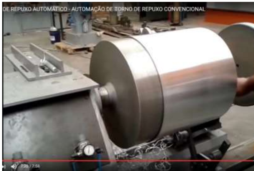
Figura 05: Final do processo – Placa circular se torna um cilindro
