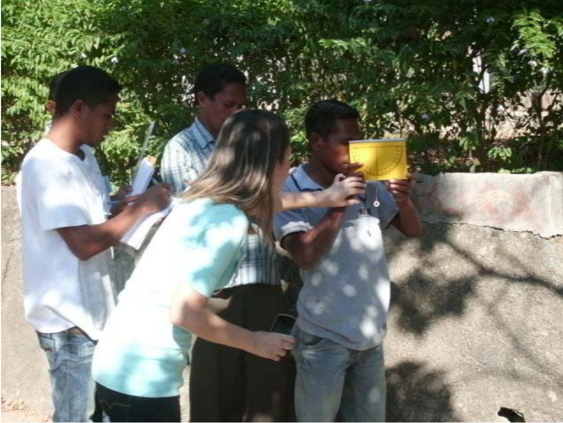
Cálculo da altura do laboratório de Matemática com teodolito construído com transferidor, canudo, fio e um pequeno peso.
